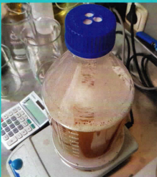
Laborflasche mit Sterilluftfilterkappe (zur Not desinfizierte Watte) und Magnetrührer
