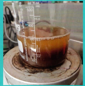
Etwas Verdünnungswasser untermischen, damit es sich besser rühren lässt
