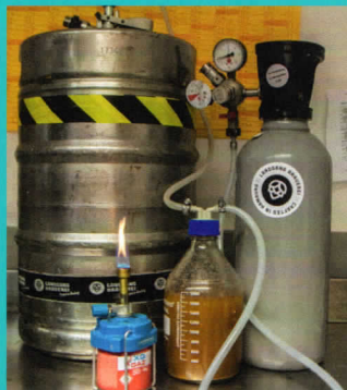
Steriler Transfer von Laborflasche ins KEG
