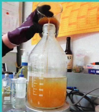
Würze in die Laborflasche mit abgekochtem Verdünnungswasser ser auf 10-12°P einstellen.
